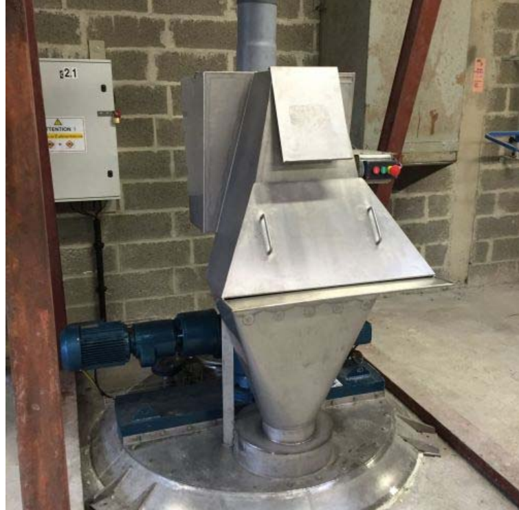
Trémie inox raccordée sur cuve de mélange et sur tuyauterie PVC d'aspiration
