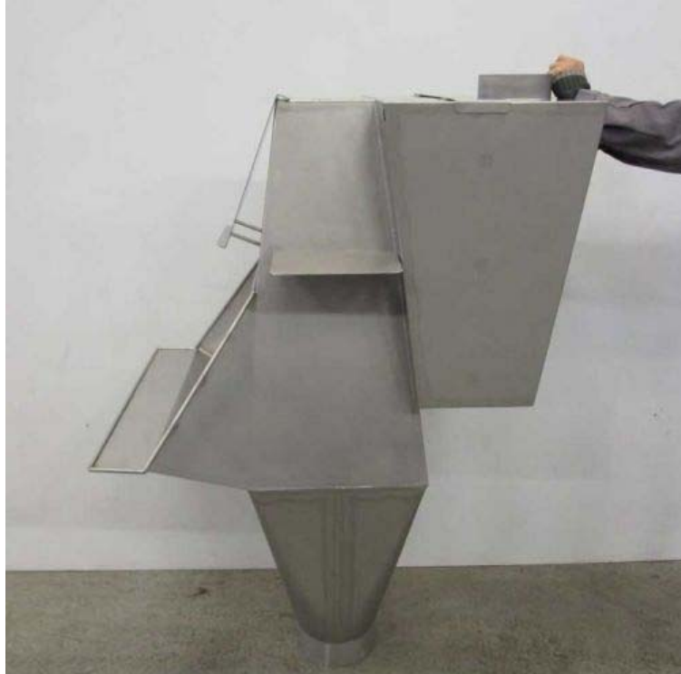
Trémie inox en fin de production et après passivation
